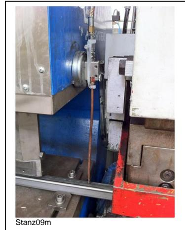
Steidle-Geräte sind seit über 20 Jahren im Hause im Einsatz, daher kam man auf uns zu. Nach der Besprechung des Projektes wurde ein Mini-Lube ML/1 direkt bestellt. Jetzt aktiviert die SPS-Steuerung der Anlage den Mini-Lube ML, solange der Vorschub arbeitet.
