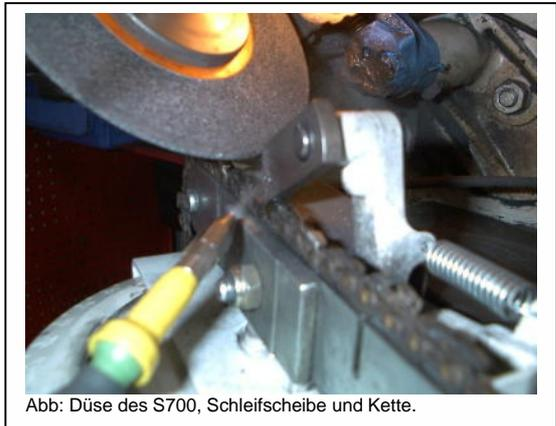
Abb: Düse des S700, Schleifscheibe und Kette.
