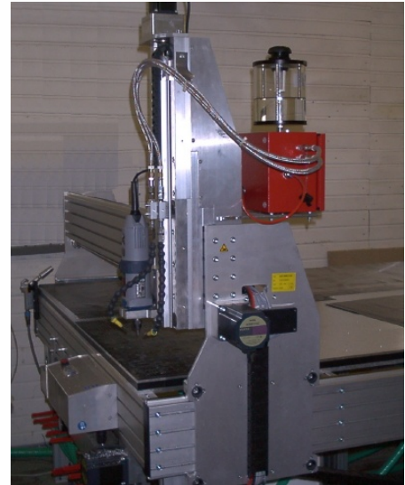
Abbildung: Links die Spindel mit den 2 Düsen, rechts oben der Lubrimat L50. (fraes028m.jpg)
