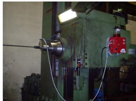
Abbildung: Rechts der T70a, mittig die Adapteraufnahme, links der Bohrer.
