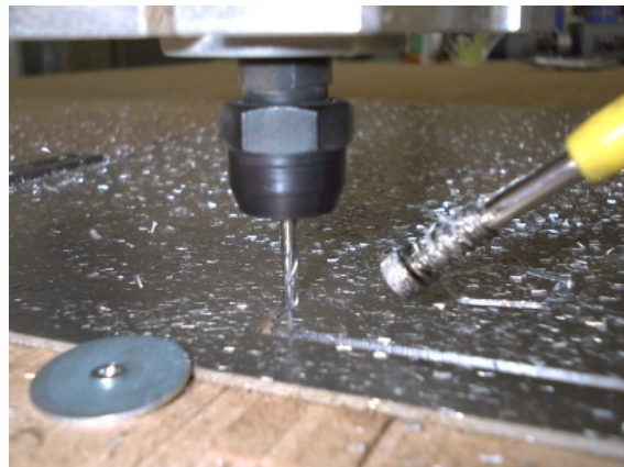
Abb.: Mittig der Hartmetallfräser, rechts die Düse des S100 (fraes27m.jpg)
