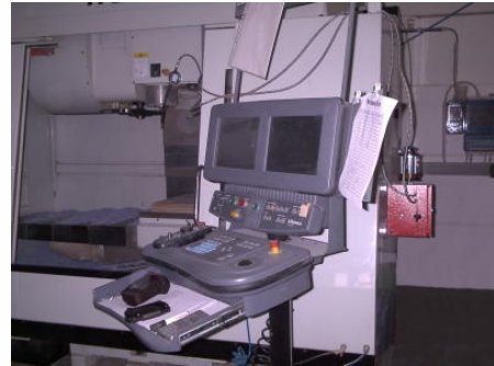
Abbildung: Bedienpult des BAZ, rechts der Lubrimat L60. (fraes026m.jpg)
