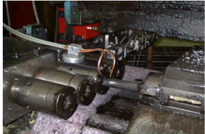
Abb.: Mittig die beiden Kupferrohrdüsen, darunter die Umformstationen (umform07m2.jpg)
