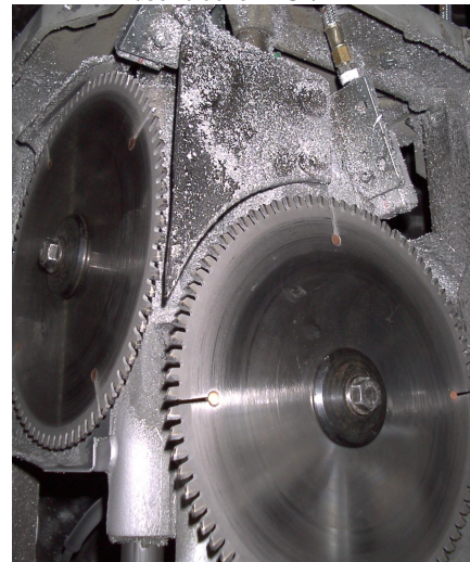
Abb. 1+2: Kreissägeblätter mit den beiden Düsenblöcken KS1/2
