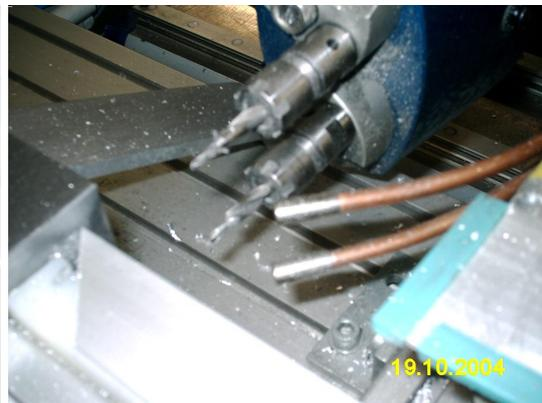
Abb.3: Düsen mit Stufenbohrern
