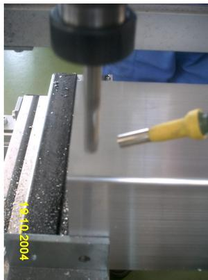
Abb.2: Düse mit Bohrer 10mm
