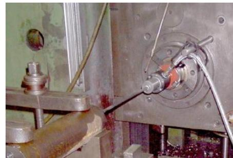
Abbildung: Rechts die Düse des T70a angeschraubt an der Adapteraufnahme, mittig taucht der Bohrer in das Werkstück ein.
