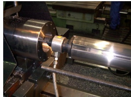
Abbildung: Mittig die Düse des T70a angeschraubt an der Drehdurchführung, links Bohrer und Werkstück (bohr017m.jpg)
