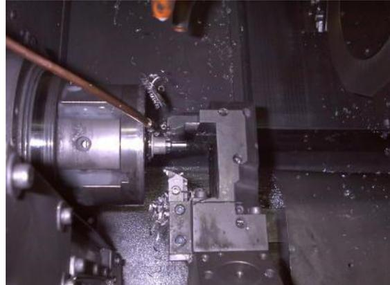
Abb. oben: die Düse des Lubrimat besprüht den Prozess. (dreh007m2.jpg)
