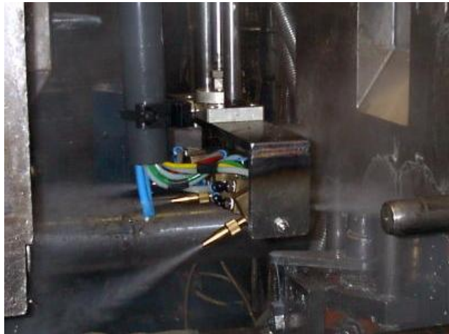
Abbildung: Die von oben eingeschwenkten Düsen besprühen die Innenseiten der Formen links und rechts. auftrag01m2.jpg
