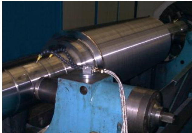
Abbildung: Zwei der vier Düsen schmieren die Lagerauflfläche der Walze lager01m.jpg
