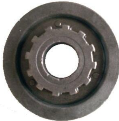
Abb. 1: Stirnrad für PKW-Automatikgetriebe (kalib01m.jpg)
